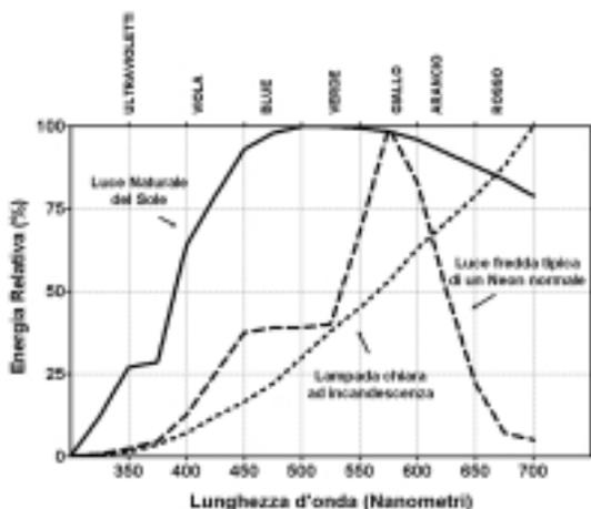
**Figura 1 – Rappresentazione schematica dello spettro di una lampadina comune e di un neon usato per l’illuminazione di ambienti interni paragonati a quello della luce solare.**
